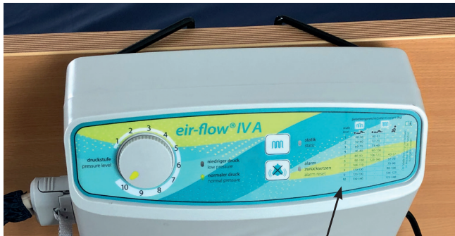
eir-flow® IV/eir-flow® IV A: Tabelle zur Unterstützung der Druckeinstellung auf der Frontseite
