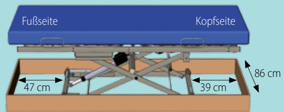
Bettkasten innen: 200 cm x 86 cm Anordnung für den Scherenhubunterrahmen (116 cm x 81 cm)
