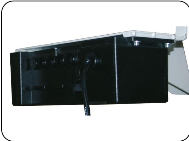
Abb. 6.2.01 – Netzteil unter der Liegefläche montiert
