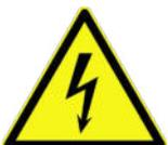
**Betreiben Sie die Steuerung nicht mit offenen Steckbuchsen!** Alle Steckbuchsen müssen mit einem Stecker oder einem Stopfen verschlossen sein. Beim Eindringen von Feuchtigkeit/Flüssigkeit besteht die Gefahr eines Kurzschlusses oder Brandes.
