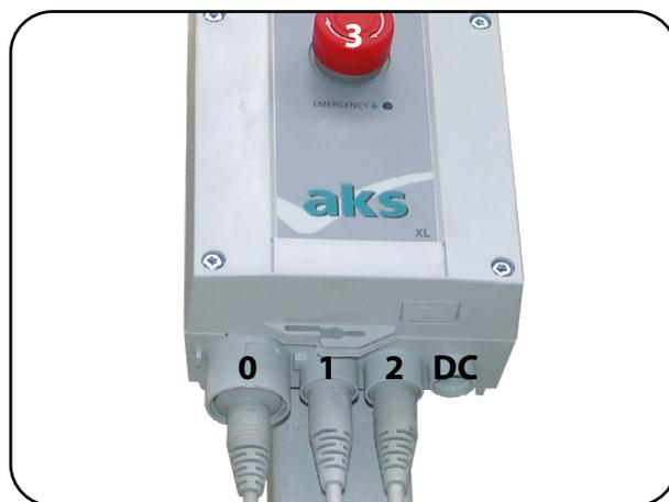
Abb. 7.02 – Steuereinheit - elektrische Spreizung
