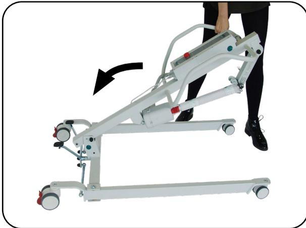
Abb. 6.2.1.03 - Standmast aufrichten
