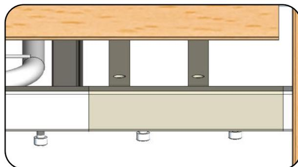
**Abb. 6.6.08 – Bettverlängerung am Fußende des Liegeflächenrahmens montiert**
