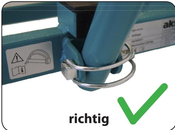
Abb. 6.1.02 – Rohrklappstecker richtig montiert
