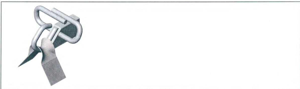
**gebogene Haken in Längsachse montiert mit Verschlussbügel (z.B. aus Rundstahl)**
