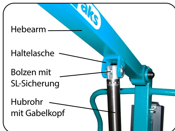
Abb. 6.2.06 – Montage des Hubantriebes
