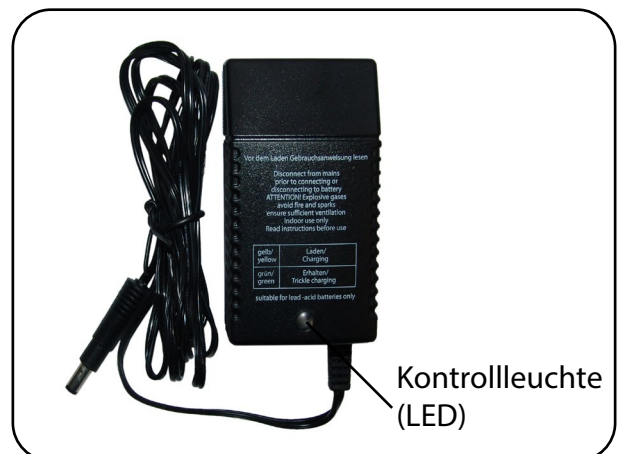
Abb. 8.7.06 - Ladegerät mit Zuleitung
