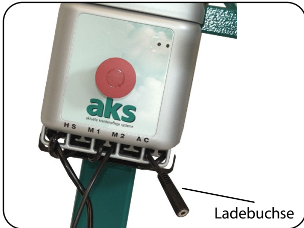
Abb. 8.7.05 – Steuereinheit mit Ladebuchse
