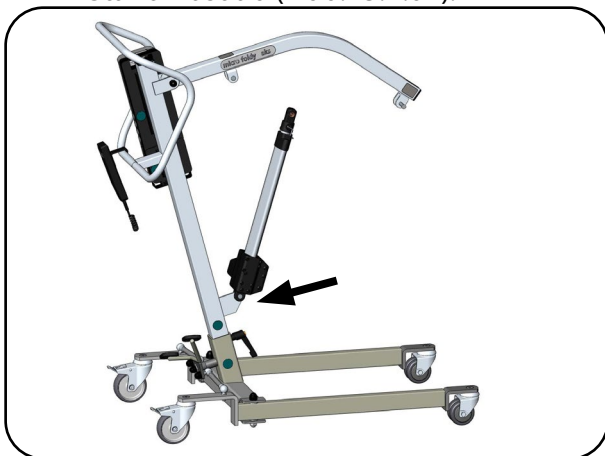
Abb.13.2.01 – Demontage des Hubantriebs
