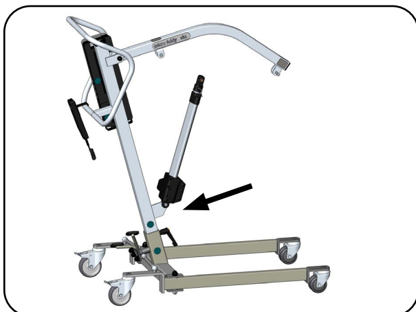
Abb. 6.2.06 – Montage des Hubantriebs
