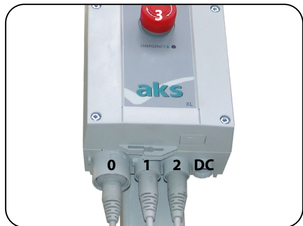
Abb. 7.02 – Steuereinheit - elektrische Spreizung
