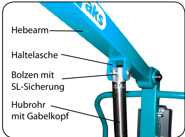
Abb. 6.1.10 – Motorlasche am Hebearm
