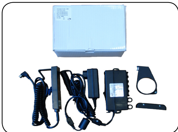
Abb. 6.3.01 - Steuerung, Handbedienung, Netzteil aus der Kartontage entnommen
